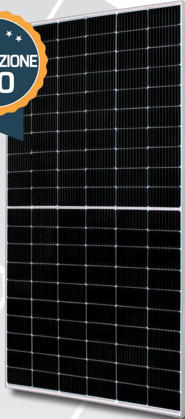
X-HALF CUT N-Type serie TOPCON prevede l'introduzione di un sottile strato di ossido tra i contatti metallici e il wafer di silicio, che apporta significativi miglioramenti nell'efficienza di conversione delle celle e nelle prestazioni di generazione di energia.
